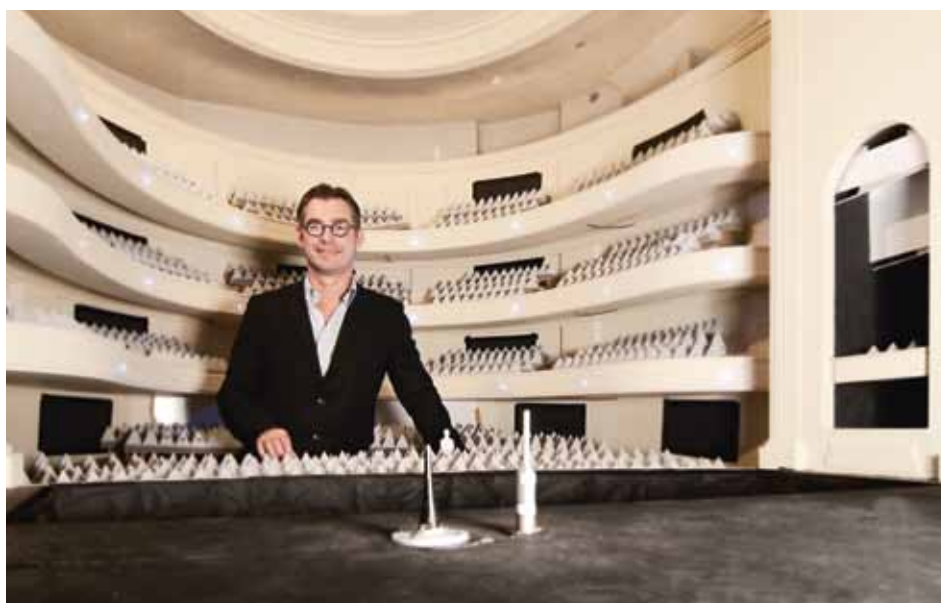
Chefakustiker Martijn Vercammen installiert einen Kunstkopf für Schallmessungen im Akustikmodell (M 1:10)
